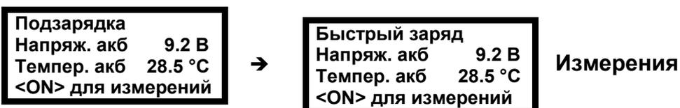
При питании от сети, индицируется напряжение аккумулятора и его температура. Для включения прибора нажать кнопку **ON**
